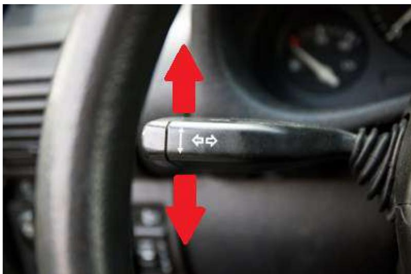
Рисунок 4 – Подрулевой переключатель указателя поворотов
